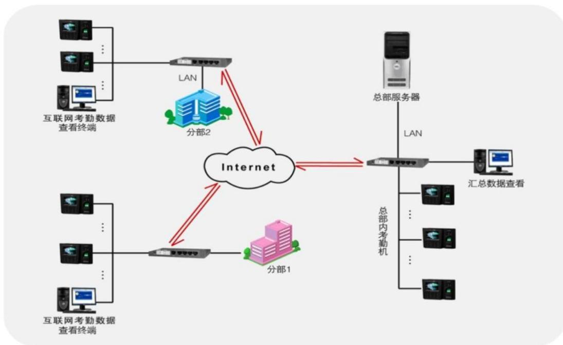
通芝 T302 标准版人脸考勤系统是一套集考勤机硬件和考勤机软件为一体的整体解决方案。考勤软件的规格型号为 T302，考勤机硬件的规格型号为 Face302，硬件为一款互联网智能考勤机，支持人脸+指纹的多种考勤方式。软件可以部署在用户自己提供的电脑服务器上，也可以部署在通芝科技提供的专业的阿里云服务器上，享受阿里云提供的专业的安全与售后服务体系。
